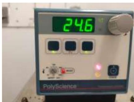
Recirculador de agua común para mantener la celda a 25 °C.
