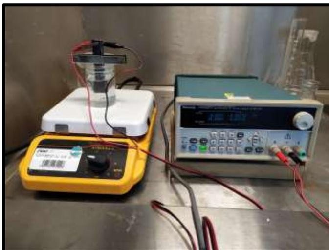
Figura 7.4. Electrólisis para la remoción de acero al carbón de la barra de hierro.
