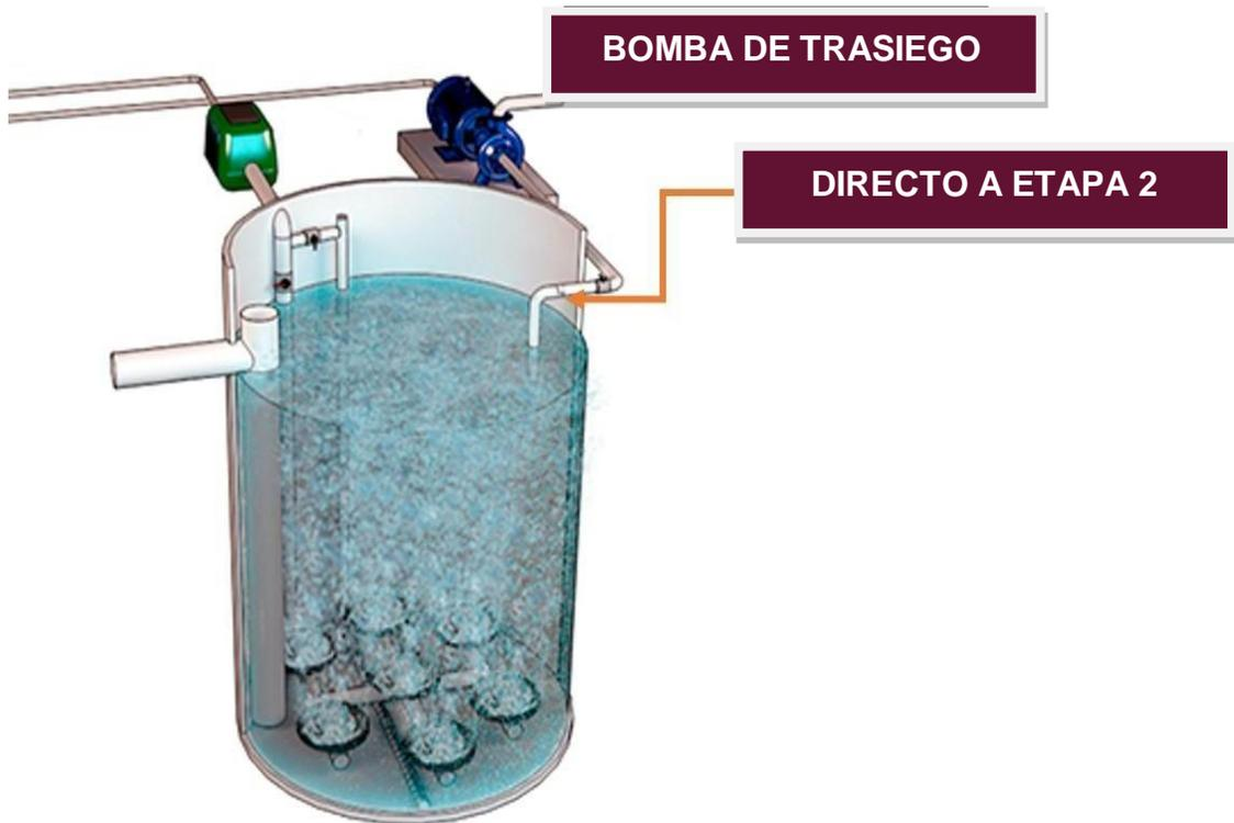
Fig 35. Método de oxidación aeróbica
