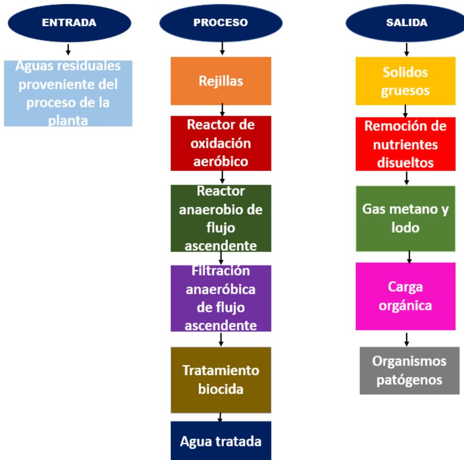
Fig. 20 Diagrama de flujo de la planta de tratamiento
