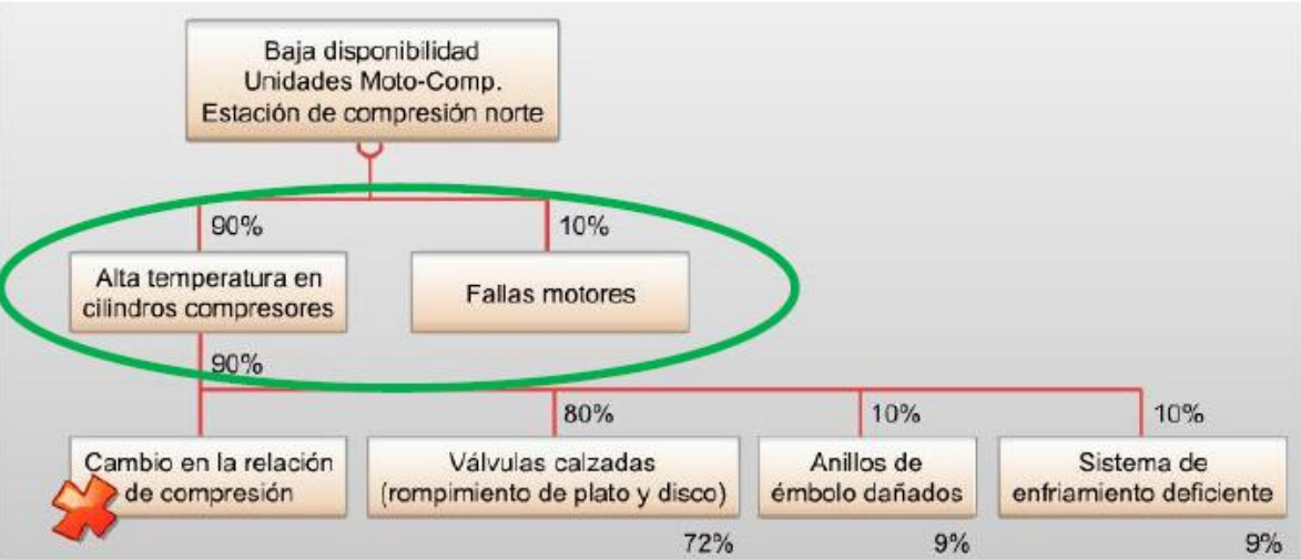
Ilustración 13 Problemas causados (Petróleos Mexicanos [PEMEX], 2019).
