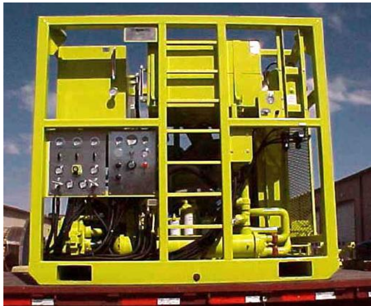
Ilustración 2 Unidad de potencia (Cose, 2015, p. 24).
