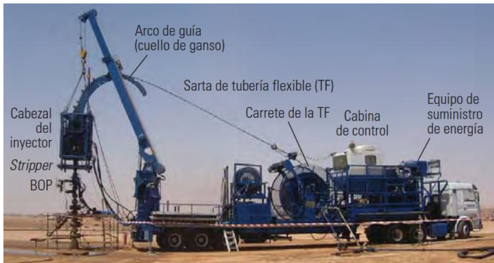
Ilustración 1 Componentes de la unidad de tubería flexible (Cose, 2015, p. 23).
