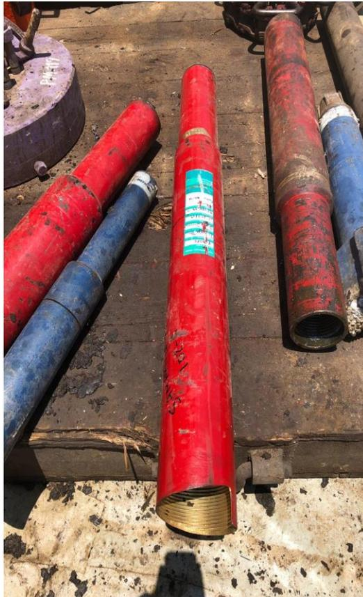
Ilustración 39 Bowen Over Shot 150 para tubería de 7"
