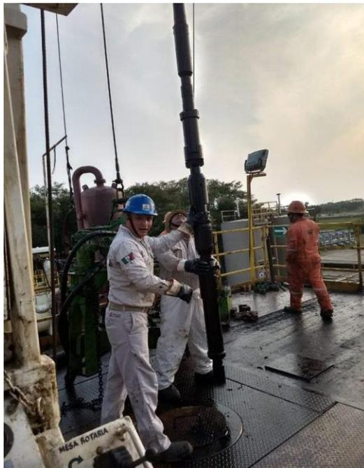
Ilustración 47 Empacador PFH extraído en el pozo Ayocote 03
