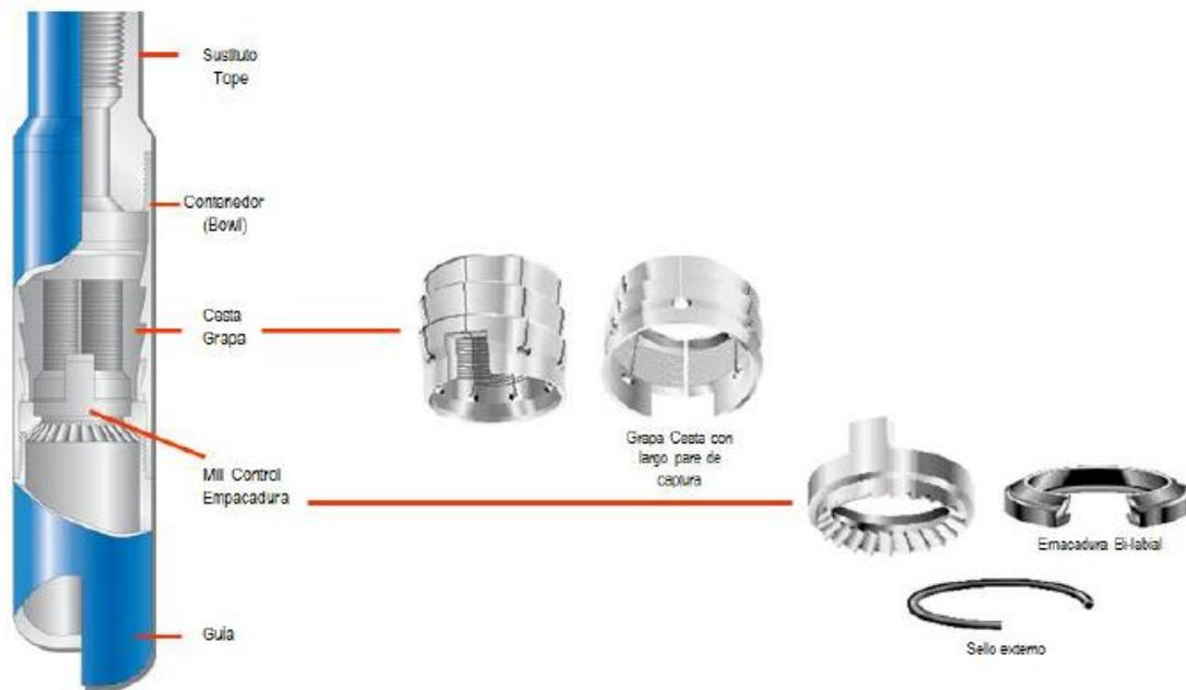
Ilustración 9 Pescante de cuñas con grapa tipo canasta (Services Oil Tools, 2013, p.4-30).
