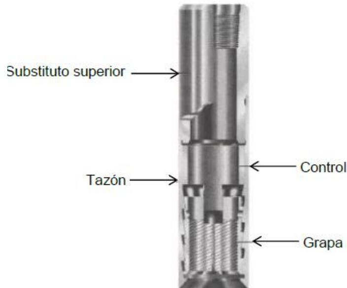
Ilustración 10 Pescante de cuñas con agarre corto (Services Oil Tools, 2013, p.4-30).
