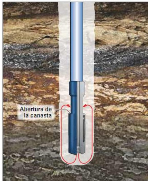
Ilustración 2 Canasta de recuperación (Services Oil Tools, 2013, p.4-30)
