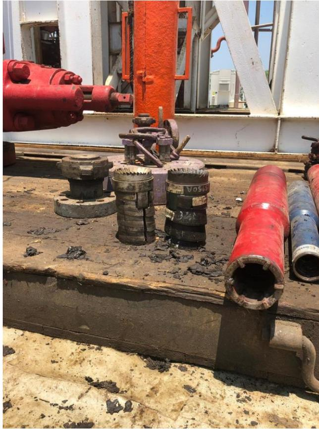
Ilustración 40 Herramientas para la pesca del empacador PFH en el pozo Ayocote 03
