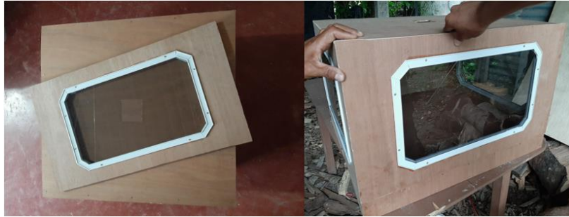
Figura 39. Colocación del cristal en las ventanillas.
