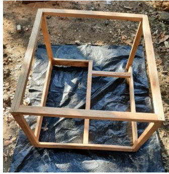
Figura 35. Estructura de cabina hecha con madera.
