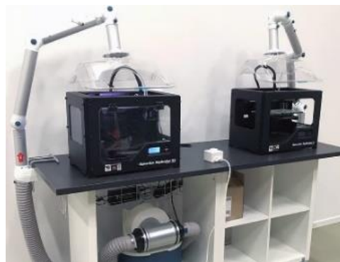
Figura 12. Sistema de extracción de humo y polvo.
