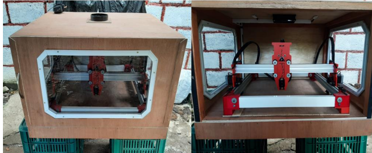
Figura 47. Colocación de la máquina dentro de la cabina.
