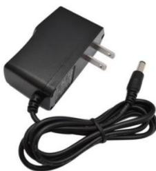
Figura 44.- Fuente de poder 12V a 2A.
