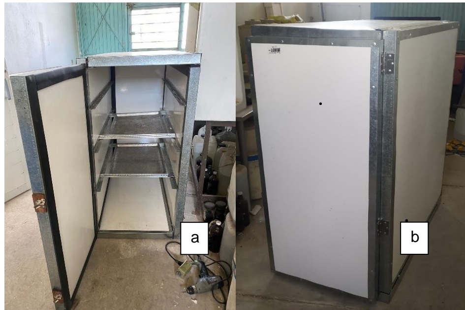
Figura 40. Construcción de cámara de secado (Fuente propia).
