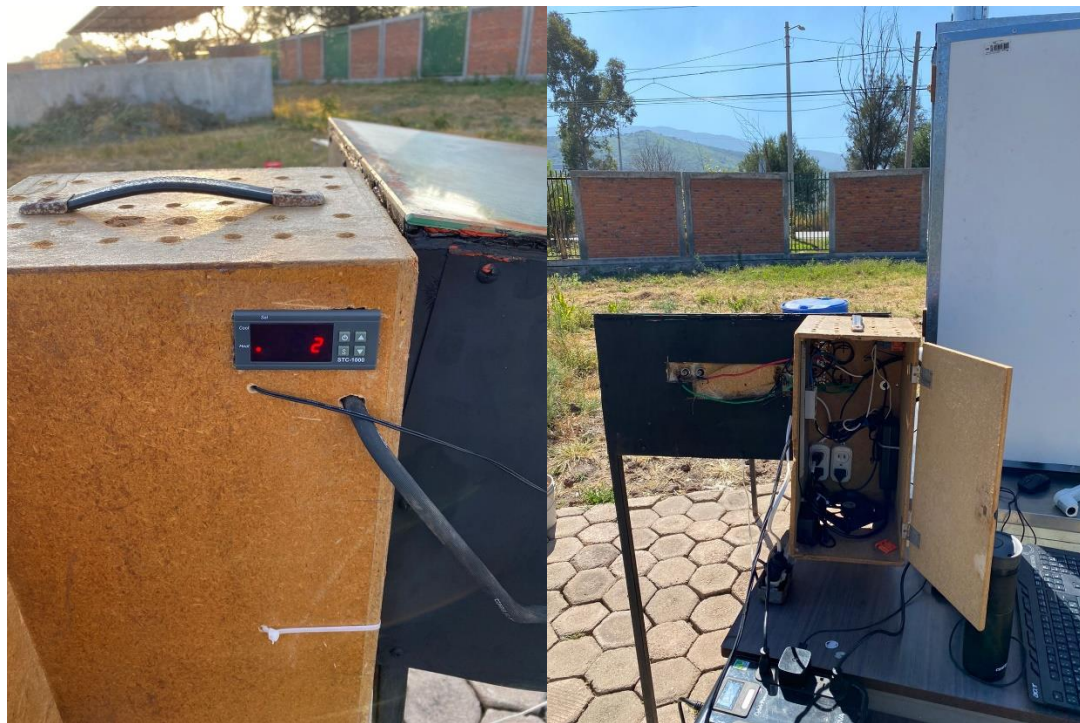
Figura 41. Control de temperatura del secador solar híbrido (Fuente propia).
