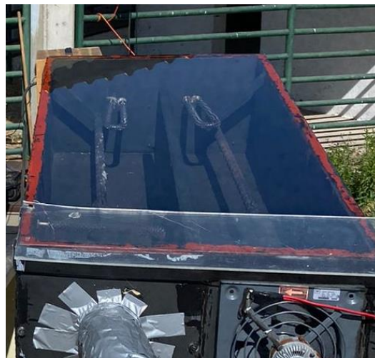
Figura 39. CSH con sistema auxiliar de calentamiento de resistencias eléctricas (Fuente propia).
