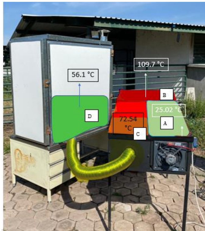
Figura 51. Secador solar híbrido, A) temperatura de entrada del CSH-RE, B) temperatura dentro del CSH-RE, medio, C) temperatura de salida del CSH-RE, D) temperatura de cabina de secado (Fuente propia).
