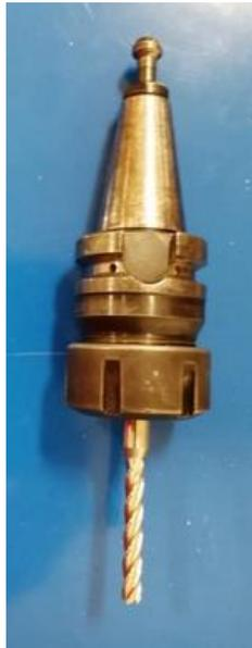
Figura 9. Fresa con vástago 6.35 mm.
