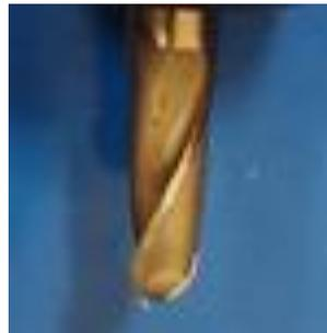
Figura 105. Estado de la fresa 3 después del proceso.
