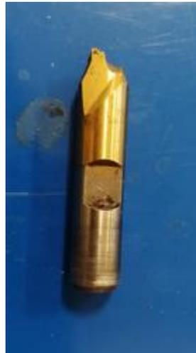
Figura 99. Fresa dañada 1.
