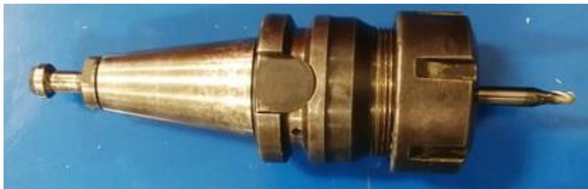
Figura 11. Fresa semicircular convexa de 4 mm.
