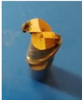
Figura 102. Fresa dañada 4.
