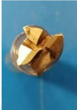
Figura 101. Fresa dañada 3.
