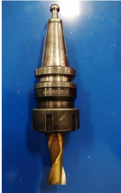
Figura 8. Fresa con vástago 19.05 mm.
