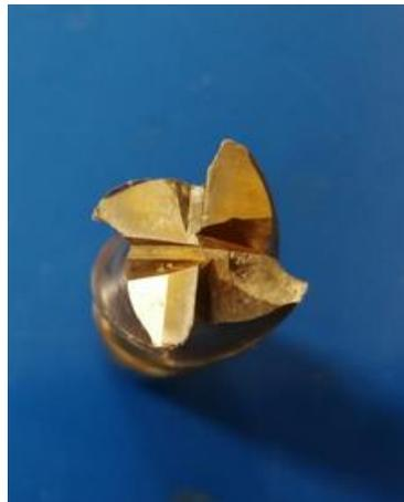
Figura 100. Fresa dañada 2.
