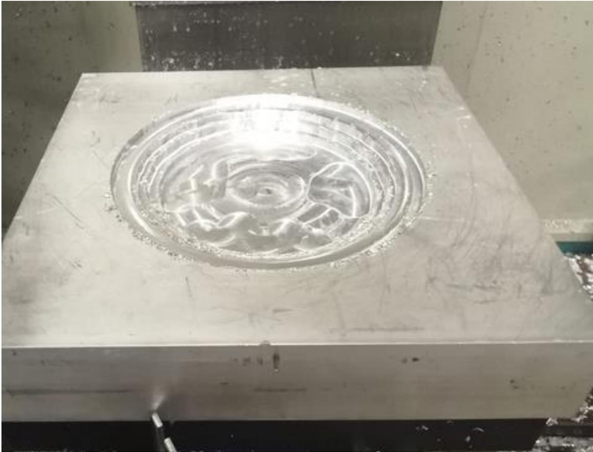
Figura 96. Desbaste 1 molde B.
