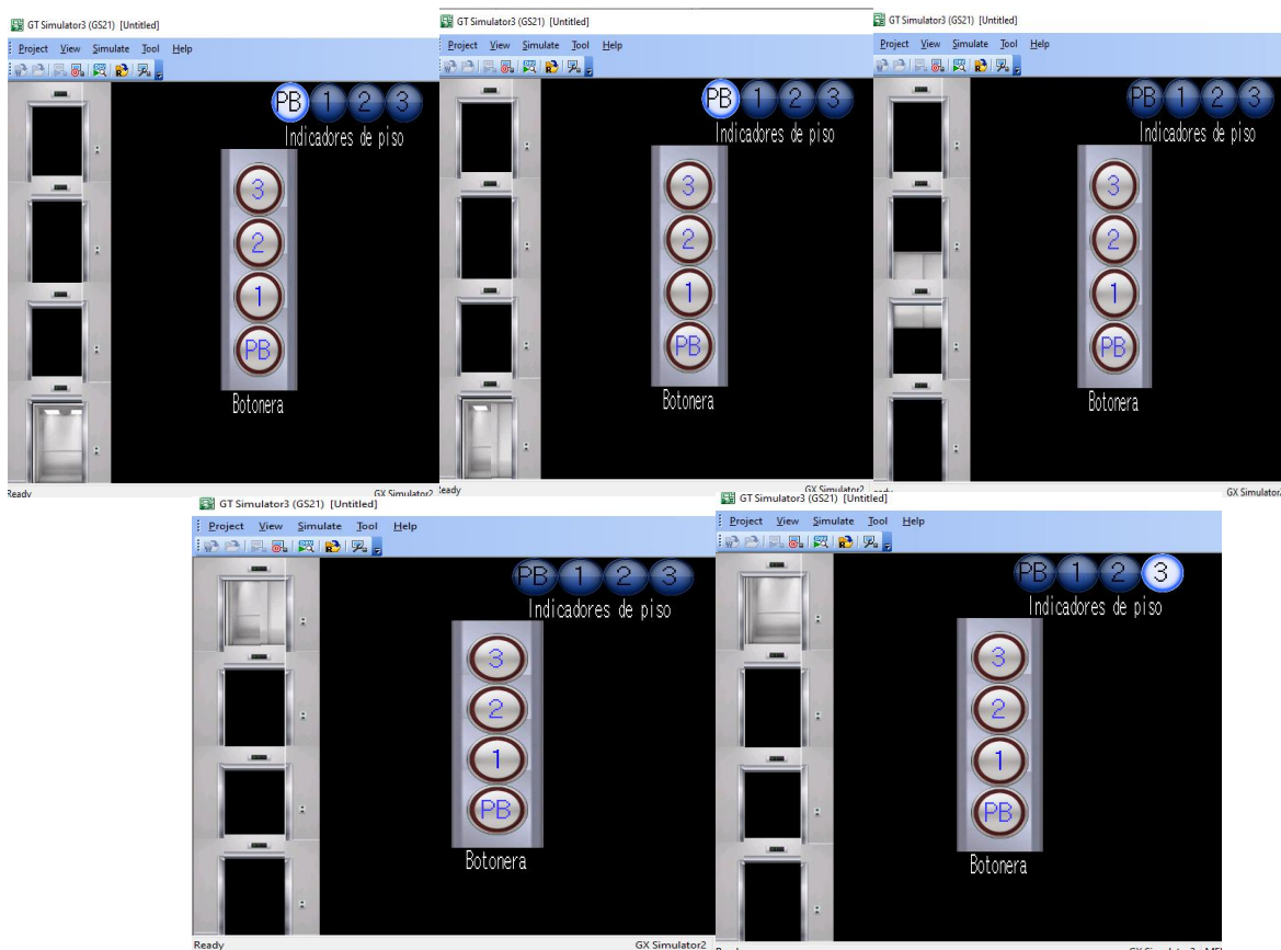
Figura 71. Simulación de la planta baja al piso 3
