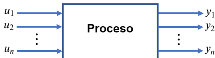
Figura 2.5: Diagrama de bloques de un proceso MIMO.
