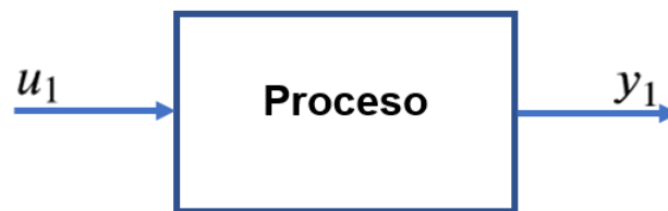
Figura 2.4: Diagrama de bloques de un proceso SISO.
