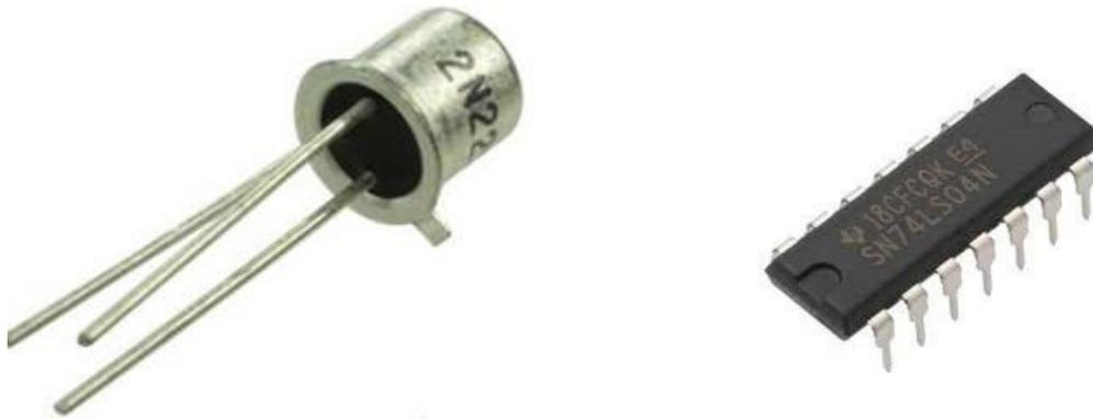
Fig. 19 Transistor 2N2222A / compuerta NOT 7404.
