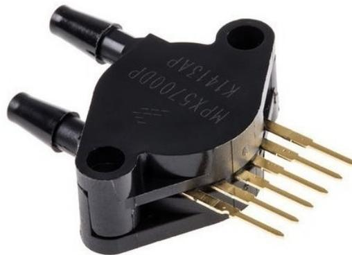
Figura 1.2: Sensor diferencial de presión MPX5700
