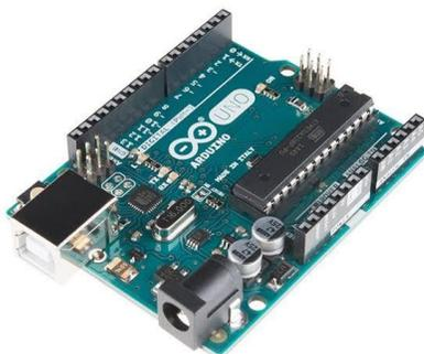
**Arduino** es una plataforma para programar algunos microcontroladores de la familia AVR de Atmel y también microcontroladores Atmel ARM Cortex-M0+ o Intel y un hardware con ese MCU donde acceder físicamente a sus puertos.
