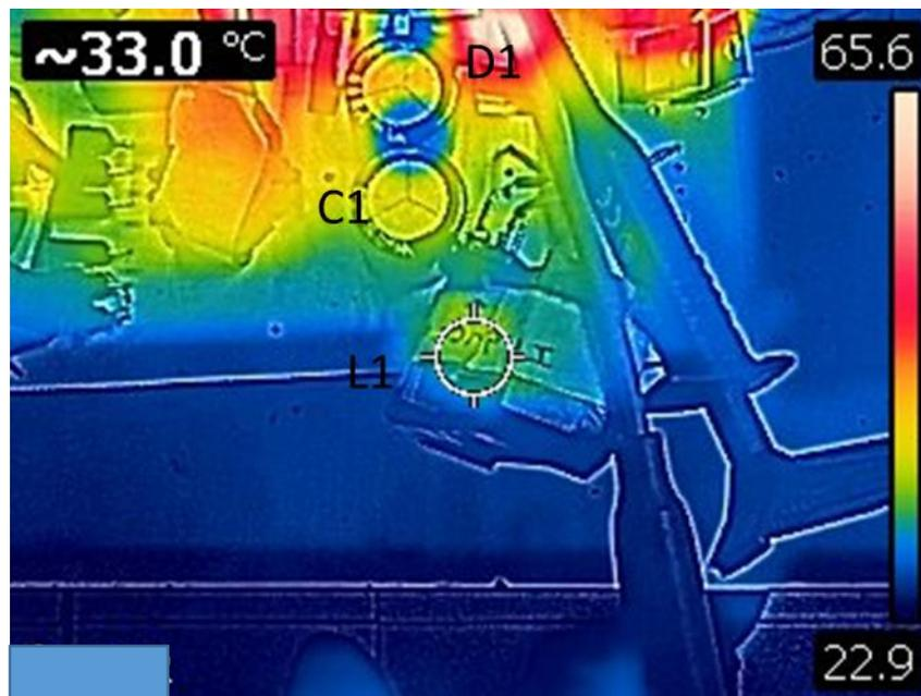
Fig. 3.57. Temperatura del núcleo con hilo de Litz.
