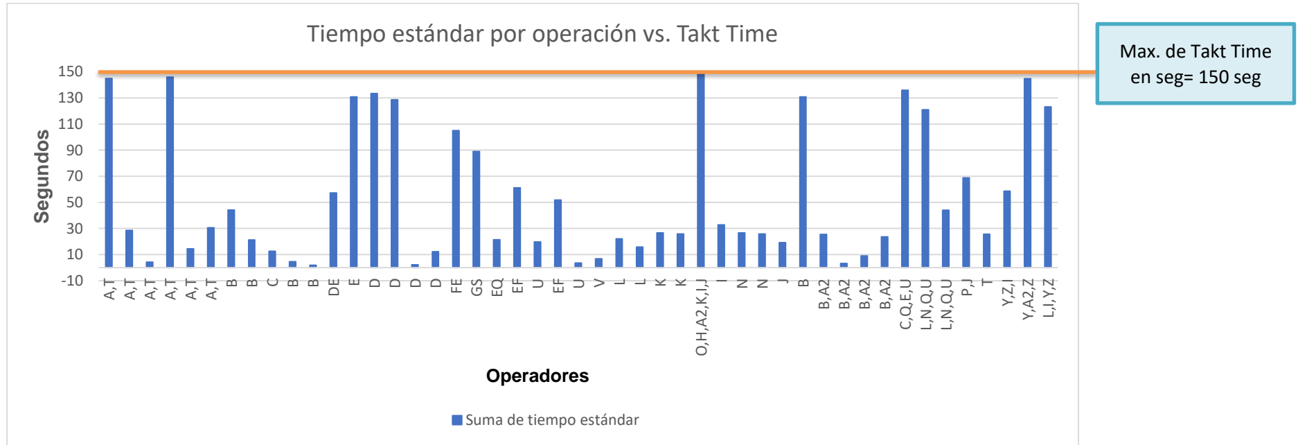
Figura: 5.11 Tiempo ciclo vs. Takt time de las operaciones de la línea de gabinetes
