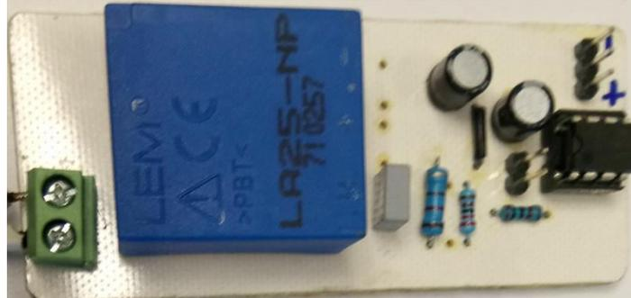
**Figura 3. 15 Sensor de Corriente**
