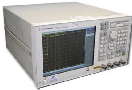
Figura 5.23. Imagen del analizador de redes Agilent E5071B ENA que se utilizará para monitorear el valor de SWR.
