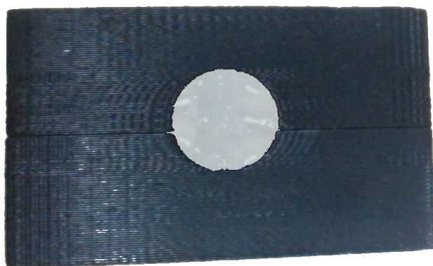
Figura 5.21. Molde de la papa lleno de phantom líquido.
