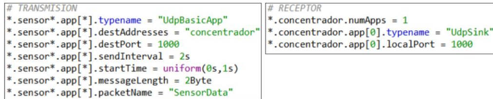
Figura 5.20. Archivo.ini; receptor y transmisor.
