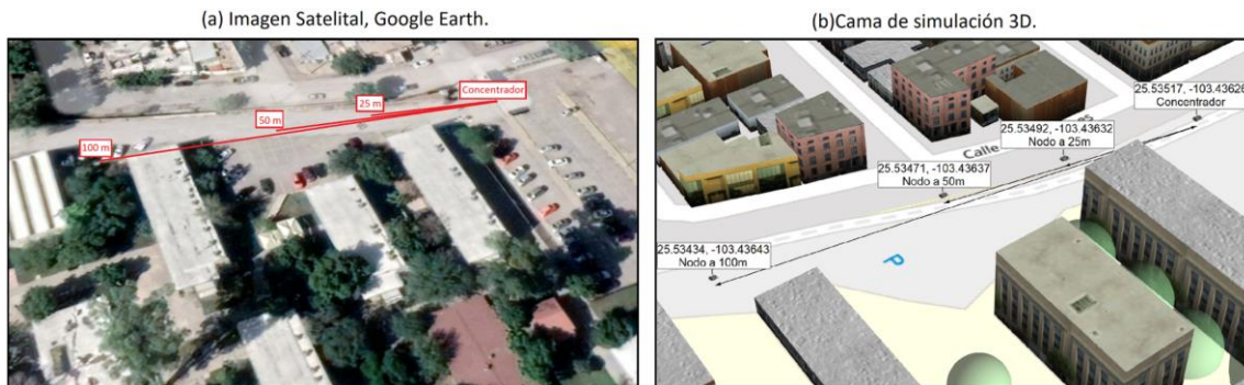
Figura 5.1. Distancias caso 1, (a) Ubicación de nodos en mapa con imagen satelital, (b) Ubicación de nodos en cama de simulación 3D.
