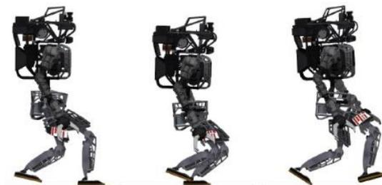
Figura 1.28. Robot Atlas corriendo (figura tomada de Dai *et al.*, 2014).
