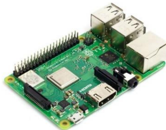
Figura 4.21. Sistema embebido Raspberry PI 3B+ (Raspberry Pi, 2011).
