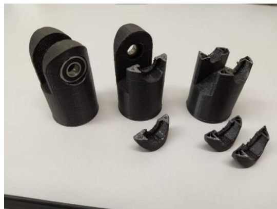
Figura 5.16. Secuencia de impresión realizando cambio de relleno en una pieza plástica que se rompía por presión.
