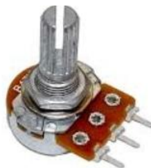
Figura 4.26. Potenciómetro de giro.
