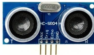
Figura 4.25. Módulo sensor HC-SR04.
