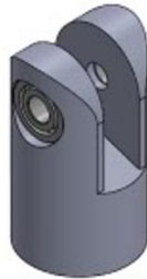
Figura 6.4. Primer diseño de articulación superior con baleros.
