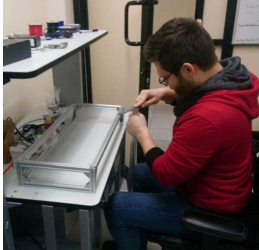
Figura 5.1. Proceso de armado de la estructura base de los dispositivos.
