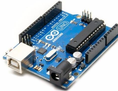
Figura 4.23. Arduino UNO (arduino, 2014).
