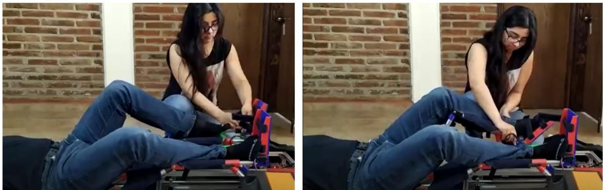
Figura 6.7. Sujeción de pie y tobillo de la pierna sana.
