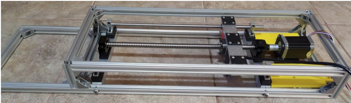
Figura 5.4. Base y elementos de transmisión ensamblados del dispositivo imitador.
