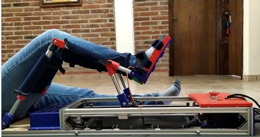
Figura 6.1. Prueba del sistema de movimiento lineal del dispositivo imitador con sujeto.
