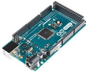
Figura 4.22. Arduino MEGA (arduino, 2014).
