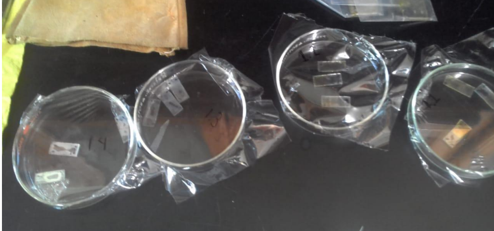
Figura 2.4. Muestras de las películas delgadas de SnS:Cu a diferentes valores de y .
