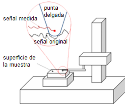
Figura 2.5. Perfilometría mecánica para la medición de espesores.
