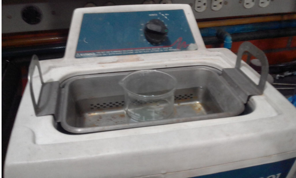
Figura 2.1. Limpieza de sustratos mediante el baño ultrasónico.
