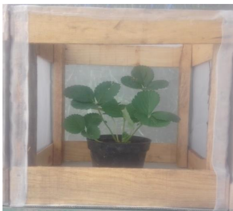
Figura 8. Unidad experimental representada por la caja entomológica de 40x40x40 cm., con planta de fresa en su interior. Fuente: Autoría propia.
