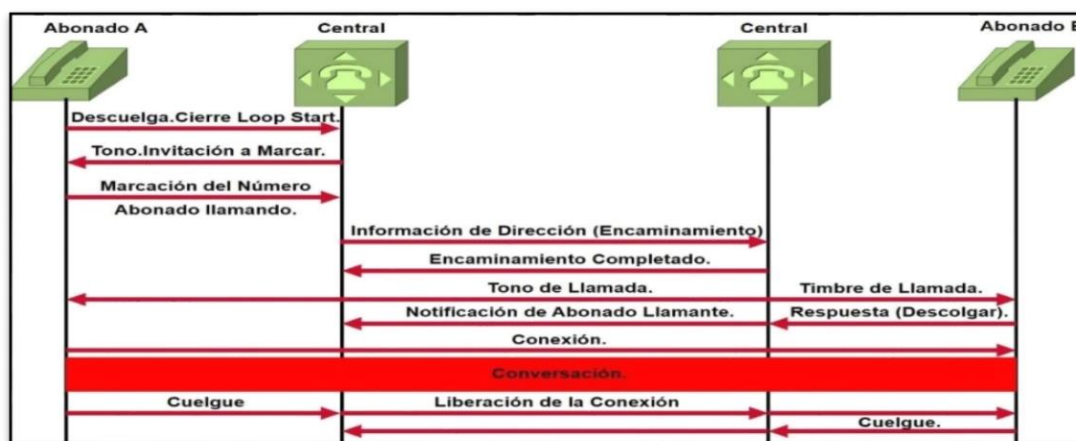
Figura 7. Señalización completa de una llamada. Fuente: Barberan, 2010
