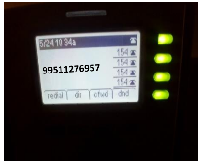
Figura 42. Marcación de un dispositivo IP/SIP a un número celular. Fuente: Elaborado de acuerdo a los requisitos del proyecto.
