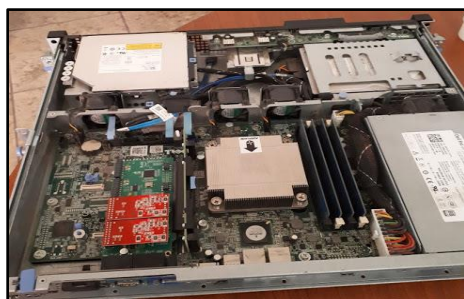
Figura 21. Fotografía del servidor DELL con la tarjeta DAHDI instalada. Fuente: Elaborado de acuerdo a los requisitos del proyecto.
