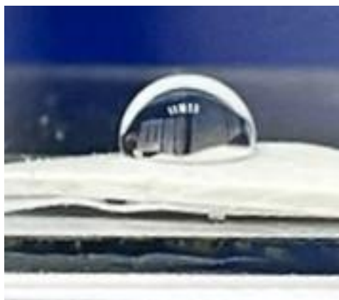
Ilustración 56 Gota de agua destilada sobre cuchara de plástico PSE. (Elaboración propia)
