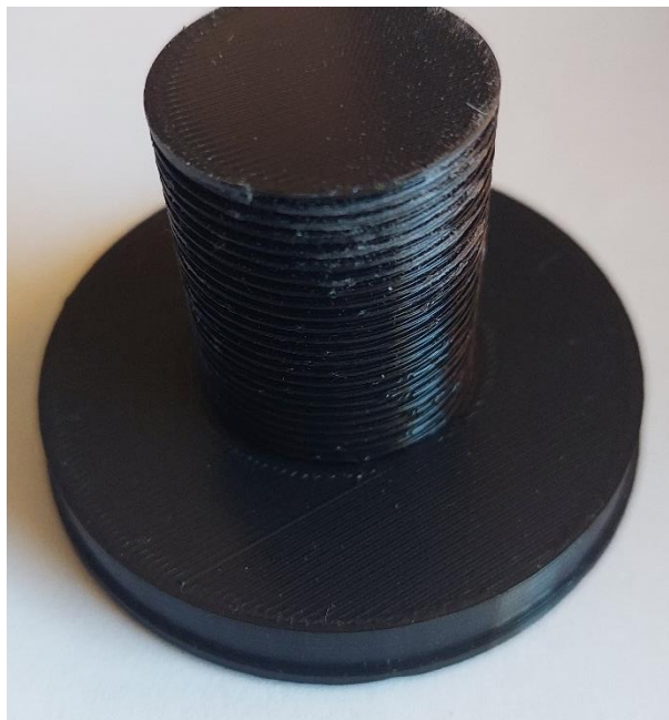
Figura 51 Impresión en 3D del dispositivo de desplazamiento parte B
