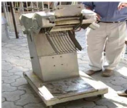
Otra de las máquinas que se encuentra en el mercado es de la marca JERSA, la cual está constituida por dos transportadores de banda uno de carga y otro de descarga, una motopolea, charolas, un área de corte, cuchillas intercambiables con doble filo, una platina ranurada, y una estructura el cual da soporte a todo el sistema con tope interior.
