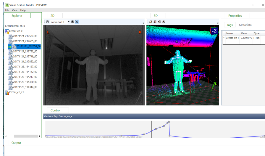
Figura 25 Programa Visual Gesture Builder mientras se etiqueta un clip de video para su posterior procesamiento
