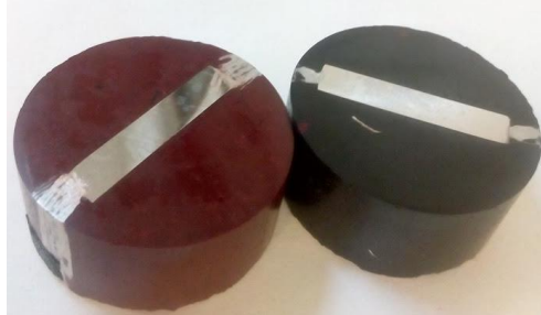
Figura 3.7 Montaje sobre baquelita de los cortes transversales de las probetas recubiertas de TiN y TiCN.
