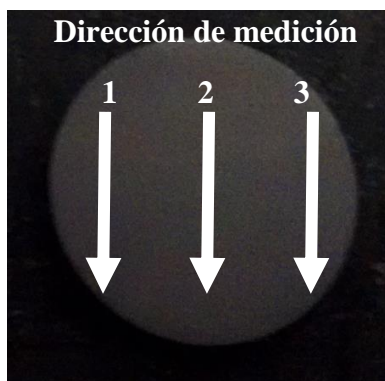
Figura 3.5 Dirección y orden de las lecturas realizadas con el rugosímetro sobre las probetas posterior al pulido.
