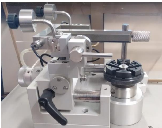
Figura 3.12 Montaje de probeta en seco.
