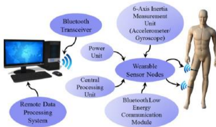
Figura 3 Sistema inalámbrico de análisis del andar para el diagnóstico de Alzheimer y Parkinson
