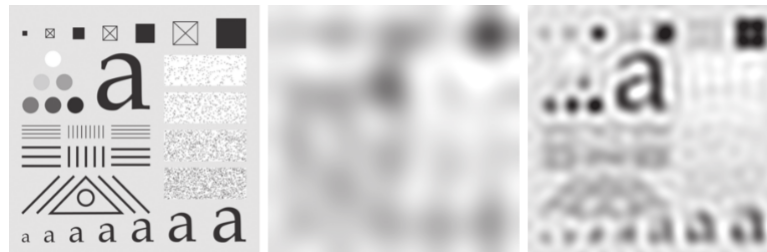
Figura 2.14: Filtro de paso bajo. Fuente: Gonzalez and Woods (2018)
