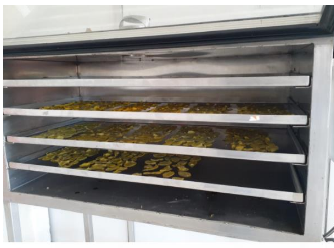
Figura 13. Deshidratador convectivo a través de un deshidratado de charolas modelo 100, marca aresma. Fuente:
