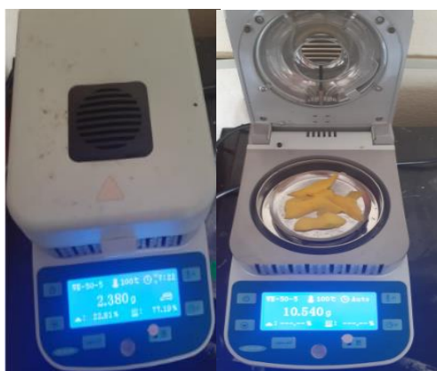
Figura 16. Determinación de humedad por medio de una termobalanza, modelo VE-50-5). Fuente: Elaboración propia, 2022.
