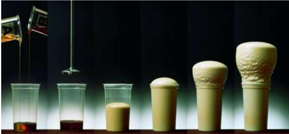
Figura 6. Proceso de elaboración del poliuretano.
