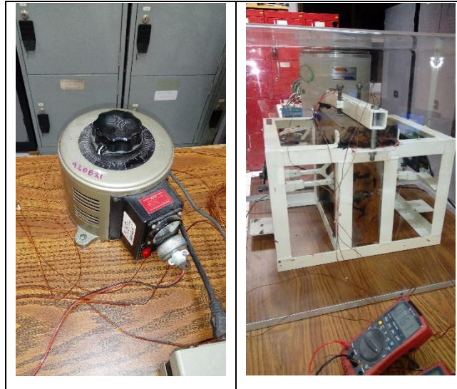
Figura 13. Conductímetro con placa de guarda.
