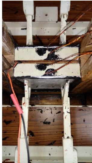
Figura 28. Instalación de probetas en conductímetro.
