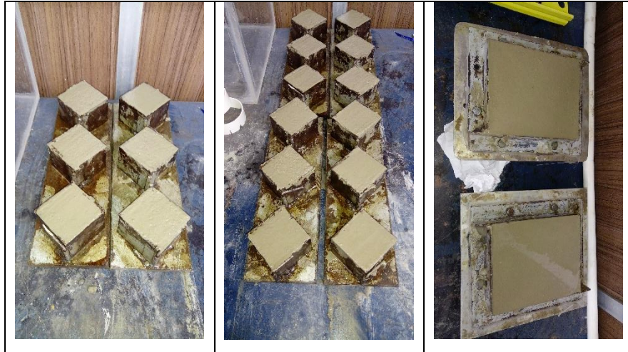
Figura 18. Probetas dentro de los moldes en Proceso de fraguado.
