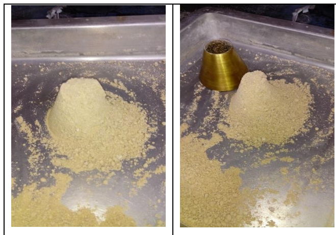
Figura 10. Procedimiento de la prueba del cono para humedad.
