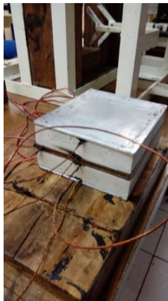
Figura 27. Sándwich con las probetas y placa caliente.
