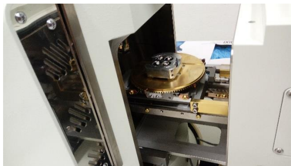
Figura 61. Instalación de las muestras en probetas del microscopio.
