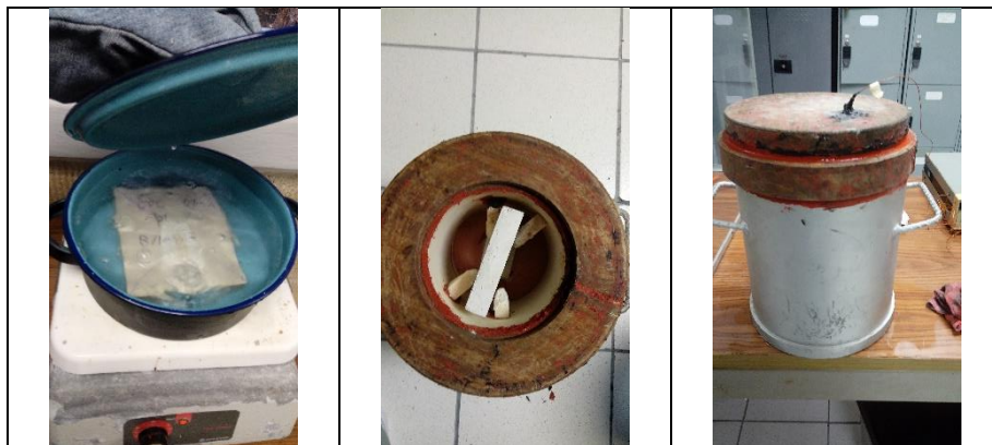
Figura 32. Procedimiento de ensayo de calor específico.
