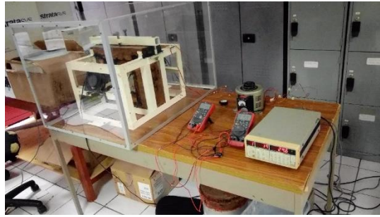
Figura 29. Ensayo de placa caliente con guarda.
