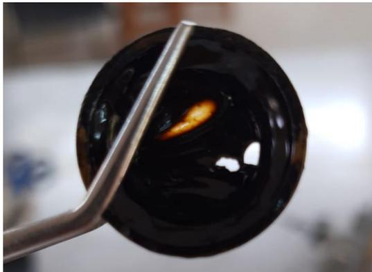
Figura 3.17 Coloración del sargazo sobre el asfalto
