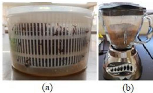
Figura 2.2 (a) Centrifuga escurridora y exprimidora de agua y (b) molido en licuadora Oster
