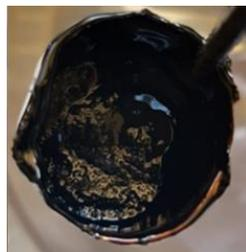
Figura 3.18 Sedimentación en tubo colapsible parte inferior
