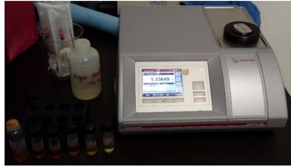
**Figura 2.27** Refractómetro AbbeMAT 300 marca Anton Paar
