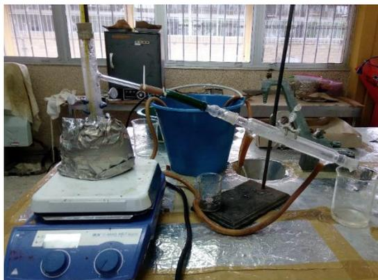
**Figura 2.10** Destilación simple de los licores azucarados.
