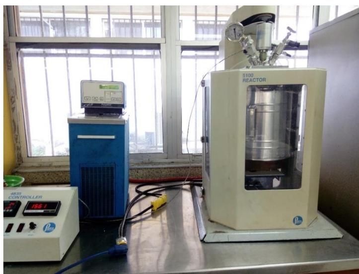
**Figura 2.3** Proceso de deslignificación utilizando un reactor PAAR Mod. 5100
