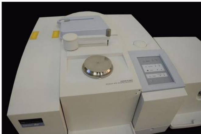
**Figura 1.25** Espectrofotómetro infrarrojo por transformada de Fourier.
