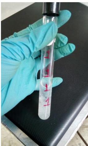
**Figura 2.15** Prueba 1 precipitada con acetona (propanona).
