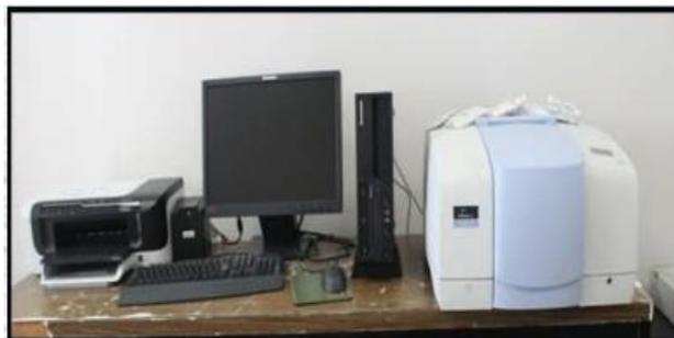
**Figura 2.23** Espectrofotómetro Infrarrojo con Transformada de Fourier
