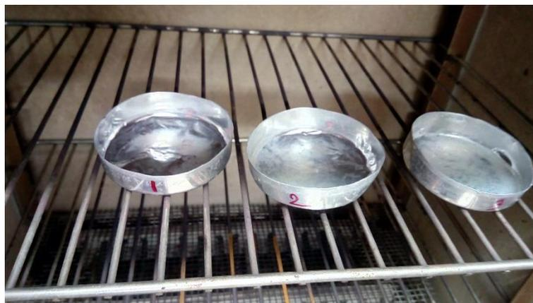
**Figura 2.18** Pruebas de polimerización en proceso de secado.
