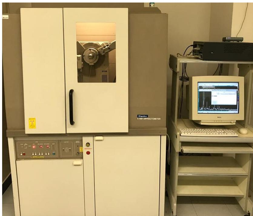
**Figura 2. 7 Equipo RIGAKU Dmax 2100 .**
