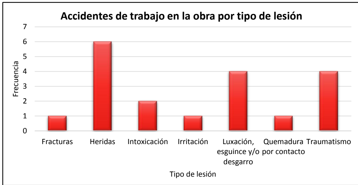
Figura 9. Accidentes de trabajo en la obra por tipo de lesión.
