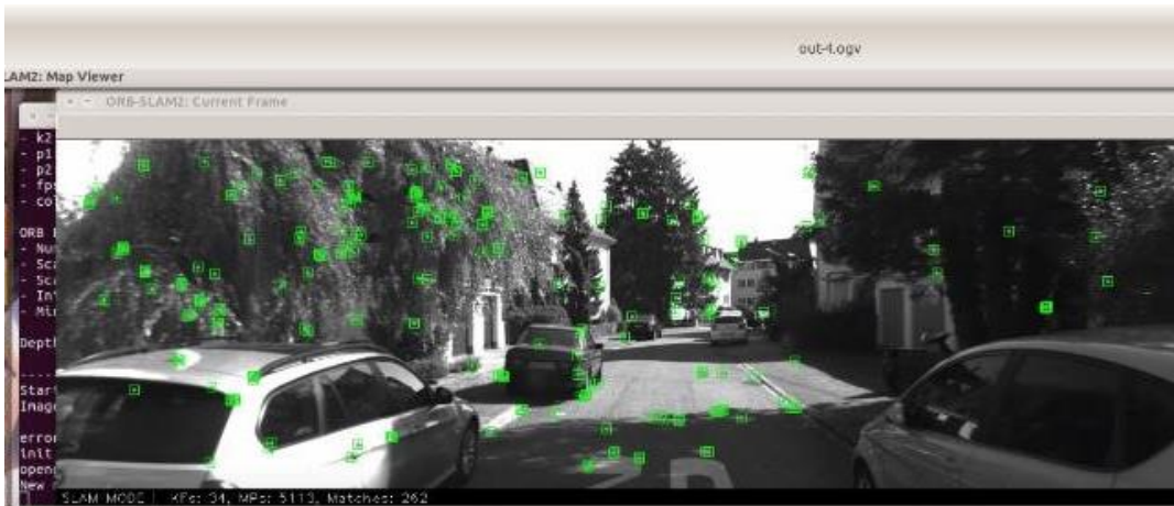
Figura 15.- Prueba de ORB-SLAM2 con dataset KITTI secuencia 02
