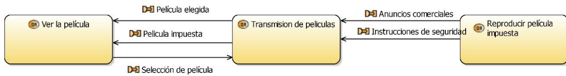
Imagen 4.4. Operación “Ver la película” modelada mediante el diagrama en blanco de interacción de actividad operativa [OAIB].
