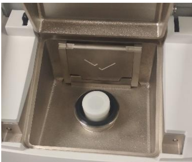
Figura 3-13 Porta Muestra cargado, colocado dentro del equipo de Fluorescencia de rayos X. Fuente: Propia
