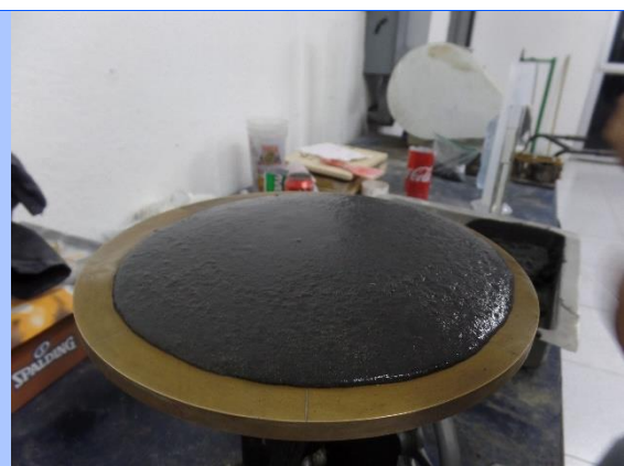
Figura 3-31 Ensayo fluidez d
