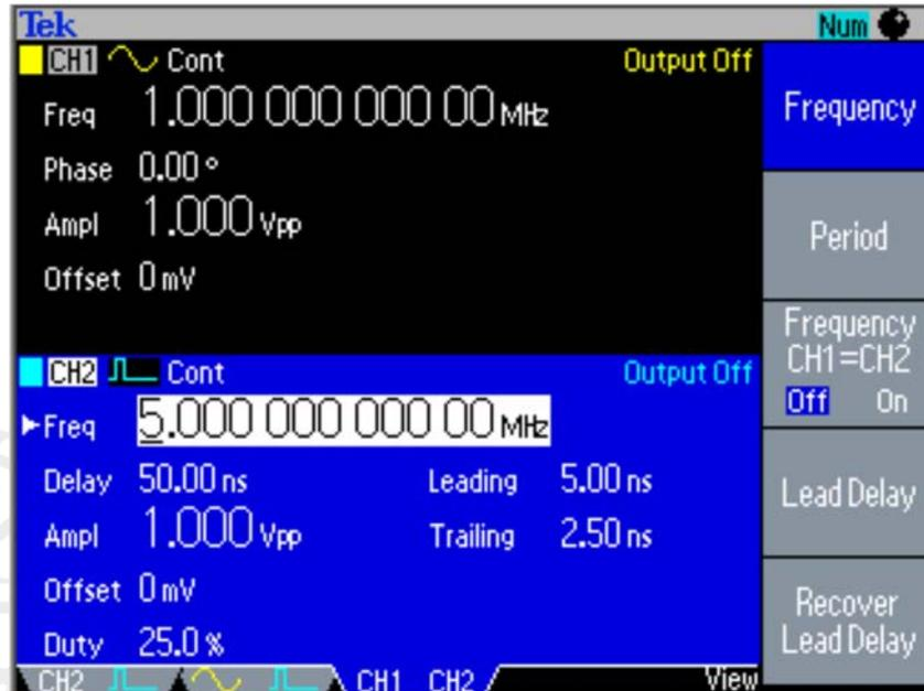
Figura 5.8: Comparación de parámetros de forma de onda (CH2 seleccionado)
