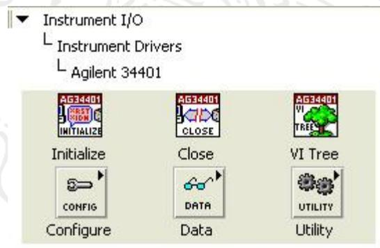
Figura 4.4 Ejemplo de controladores de instrumentos
