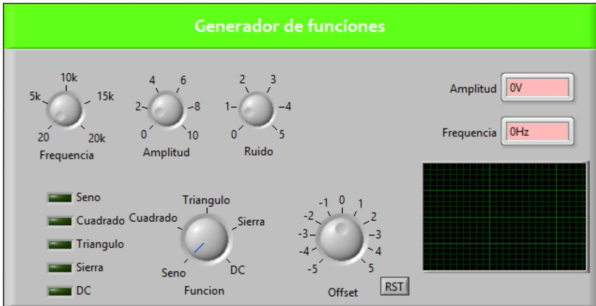
Figura 5.8 Panel frontal del instrumento virtual
