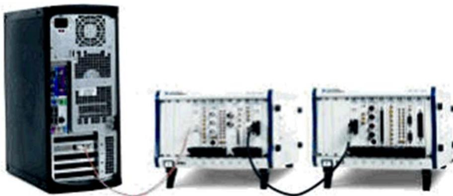
Figura 3.9 Estación de trabajo basada en GPIB y PXI
