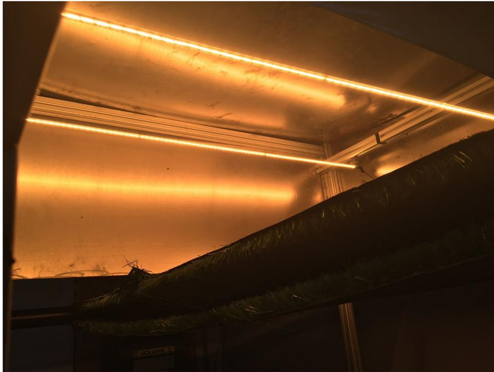
Figura 4.5. Lámparas colocadas dentro del horno.
