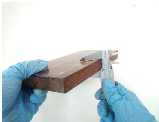
Figura 23. Prueba de grosor del tratamiento C3-1 con un calibre de precisión.
