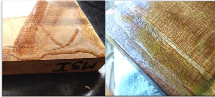
*Figura 36.* Contraste del barniz comercial Sayer Lack (izquierda) y el barniz generado EPS (derecha) en la conservación del grosor de la película aplicada al momento de secado.
