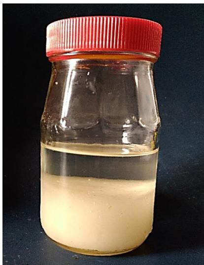
Figura 26. Prueba de disolución con D-limoneno donde claramente se observa una mezcla heterogénea sin cambios aparentes.
