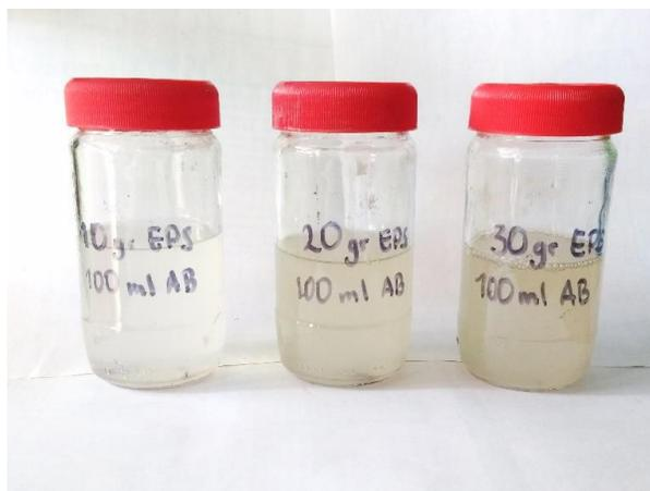
Figura 28. Primeros tres tratamientos de recubrimiento generado con acetato de etilo.
