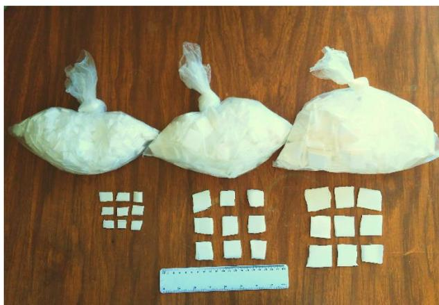
*Figura 18.* Muestra de los tres diferentes tamaños de partícula. de izquierda a derecha 1, 2.25 y 9 cm<sup>2</sup>.
