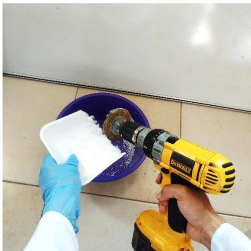
*Figura 14.* Prueba de trituración mediante bruza y taladro.
