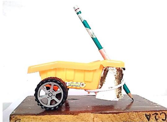
*Figura 22.* Durómetro de lápiz en prueba de dureza al tratamiento C2A-T.
