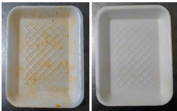
*Figura 12* Antes y después del lavado primario de un plato de EPS.
