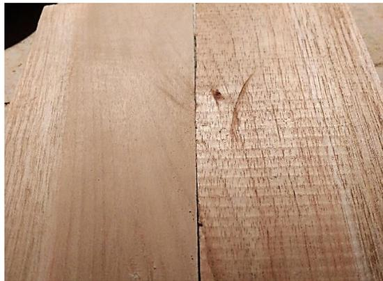
*Figura 21.* Comparación de superficies de dos maderas de Melina, una acondicionada y la otra sin acondicionar.
