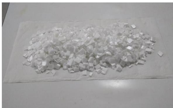
*Figura 17.* Proceso de secado de una porción del material en servi toalla del material triturado y lavado.
