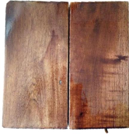
*Figura 32.* Comparación del brillo de dos maderas de cedro con barniz comercial y recubrimiento creado.
