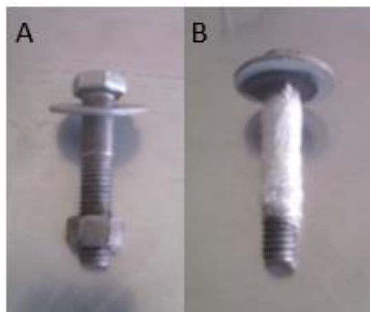
Fig. 7. A) Soportes de tuercas y tornillos utilizado B) Tornillos del soporte aislados.
