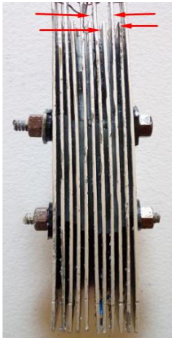
Fig. 8. Aspecto final de las láminas ensambladas e intercaladas.
