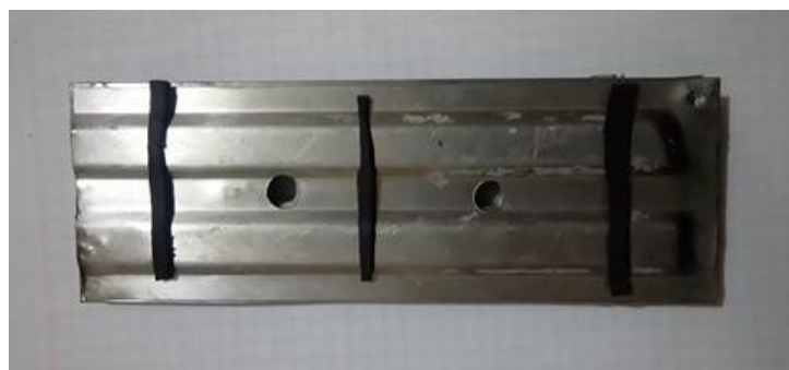
Fig. 13. Placa con bandas aislantes acomodadas en 3 posiciones.
