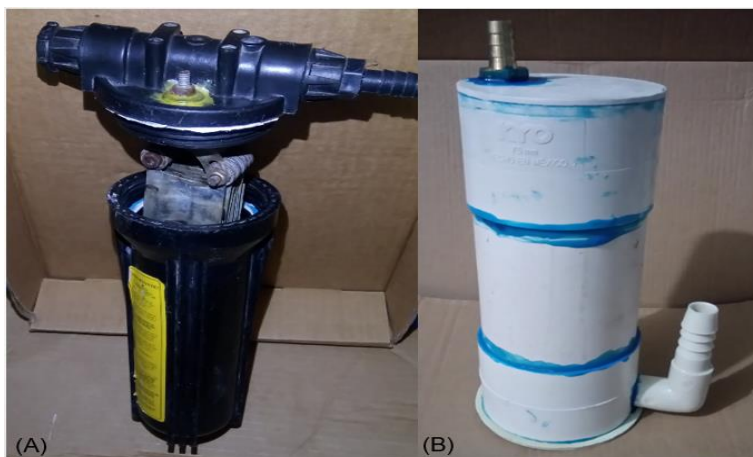
Fig. 19. A) celda armada y colocada en contenedor. B) cortaflama.
