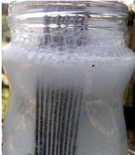
Fig. 10. Celda en funcionamiento con producción de gas.
