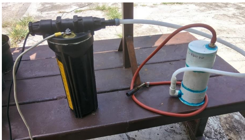
Fig. 20. Celda instalada para prueba de flama.
