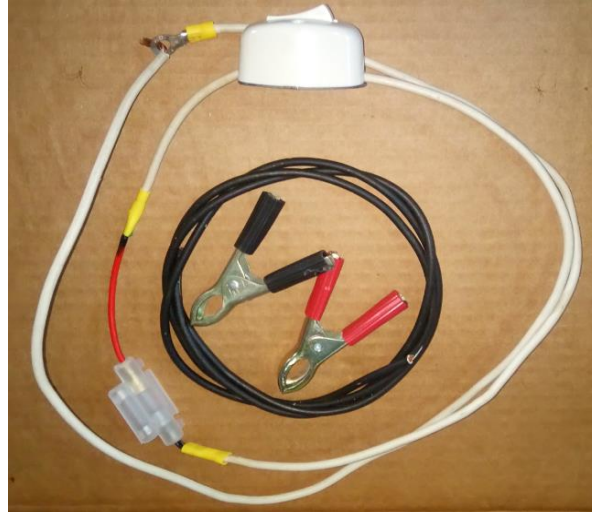
Fig. 18. Cables tomacorriente con apagador y fusible de seguridad.
