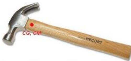
FIGURA 101.- CENTRO DE MASA Y GRAVEDAD DE UN MARTILLO.
