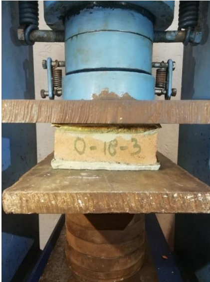
FIG. 3.3.3. 6 TABIQUE EN MÁQUINA DE COMPRESIÓN AXIAL
