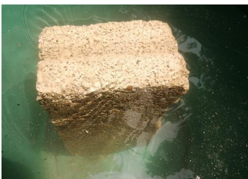
FIG. 3.4.2. 1 COLOCACIÓN DEL BLOCK DE TEPETZIL EN AGUA (AUTOR PROPIO)
