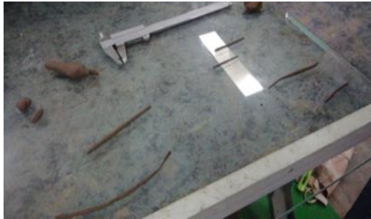
FIG. 3.2.5. 3 ROLLITOS, LIMITE PLASTICO (AUTOR PROPIO)
