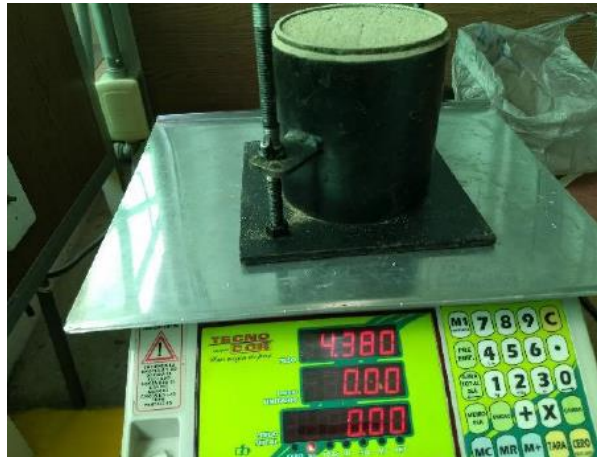
FIG. 3.2.2. 3 PESADO DEL MOLDE PROCTOR (AUTOR PROPIO)
