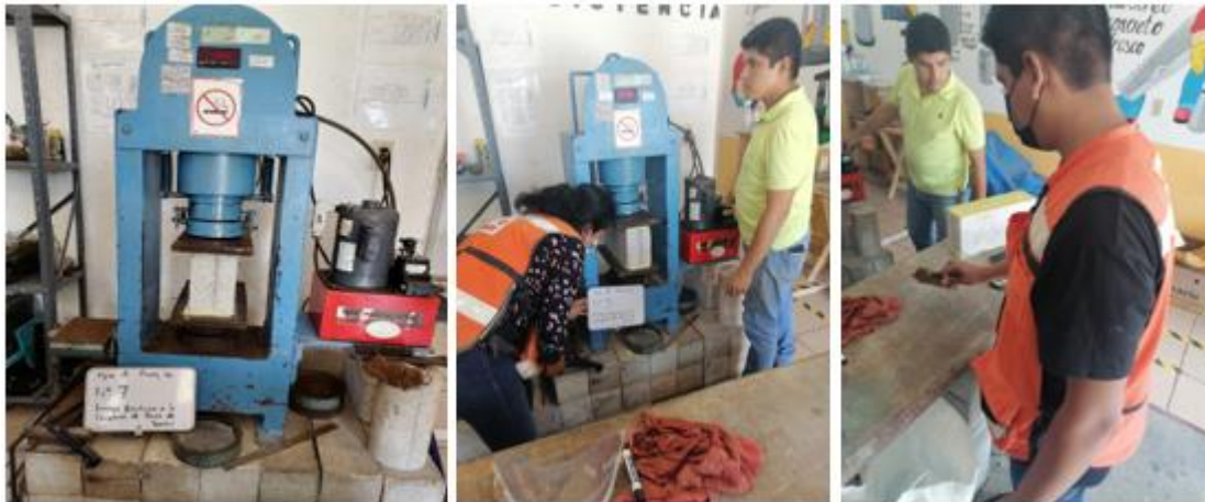
FIG. 3.5. 9 COLOCACION DE LOS BLOCK EN LA MAQUINA DE COMPRESIÓN AXIAL (AUTOR PROPIO)
