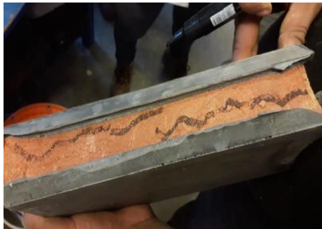
FIG. 3.3.3. 7 TABIQUE CON FALLAS (AUTOR: PROPIO)
