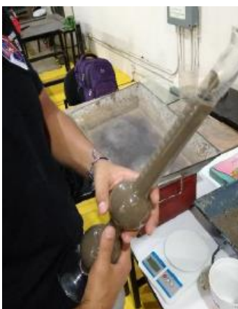
FIG. 3.2.4. 4 EXTRACCIÓN DEL AIRE ATRAPADO (AUTOR PROPIO)
