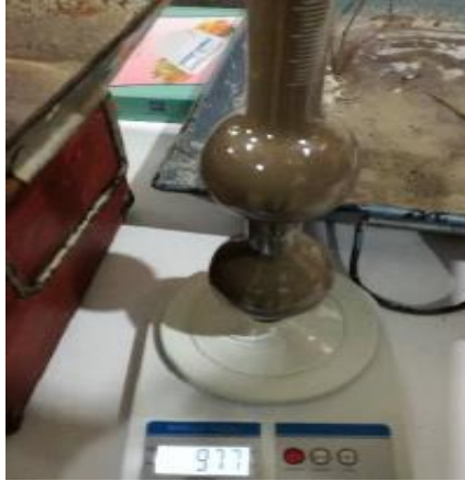
FIG. 3.2.4. 5 NUEVAMENTE SE PESA EL MATERIAL (AUTOR PROPIO)
