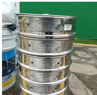
FIG. 3.2.3. 1 MALLAS PARA GRANULOMETRÍA (AUTOR PROPIO)
