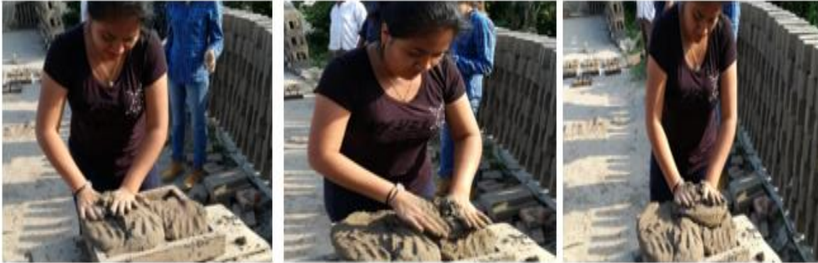
FIG. 2.2.8. 2 ELABORACION DE TABIQUE (AUTOR: PROPIO)
