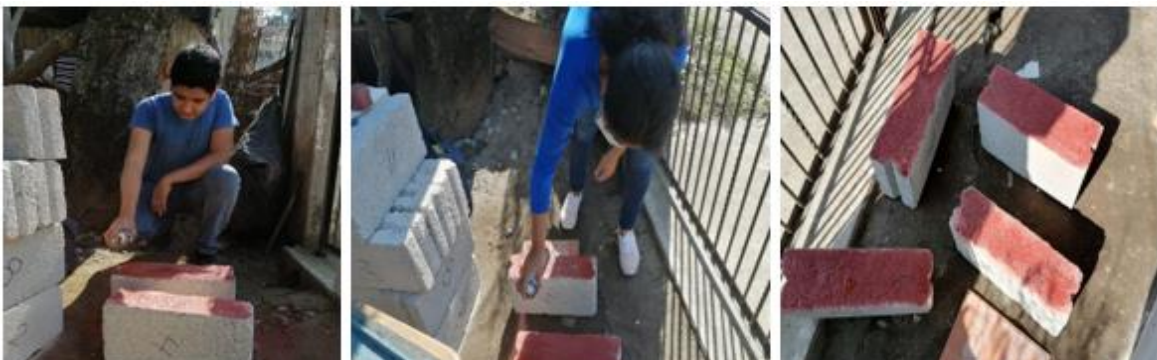
FIG. 3.5. 1 COLOCACIÓN DEL AEROSOL EN LAS CARAS DEL BLOCK (AUTOR PROPIO)
