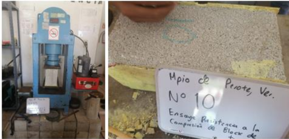
FIG. 3.5. 8 ENSAYE DE LOS BLOCKS (AUTOR PROPIO)
