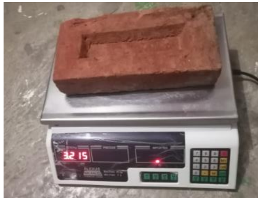
FIG. 3.3.2. 2 PESO DEL TABIQUE SUPERFICIALMENTE SECO (AUTOR PROPIO)
