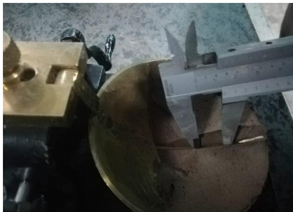
FIG. 3.2.5. 2 ABERTURA EL LA PARTE CENTRAL DEL MATERIAL (AUTOR PROPIO)
