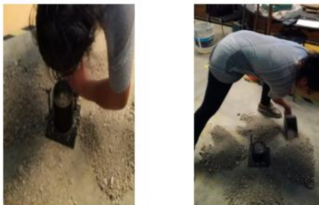
FIG. 3.1.2. 1 CUARTEO DEL MATERIAL (AUTOR PROPIO)
