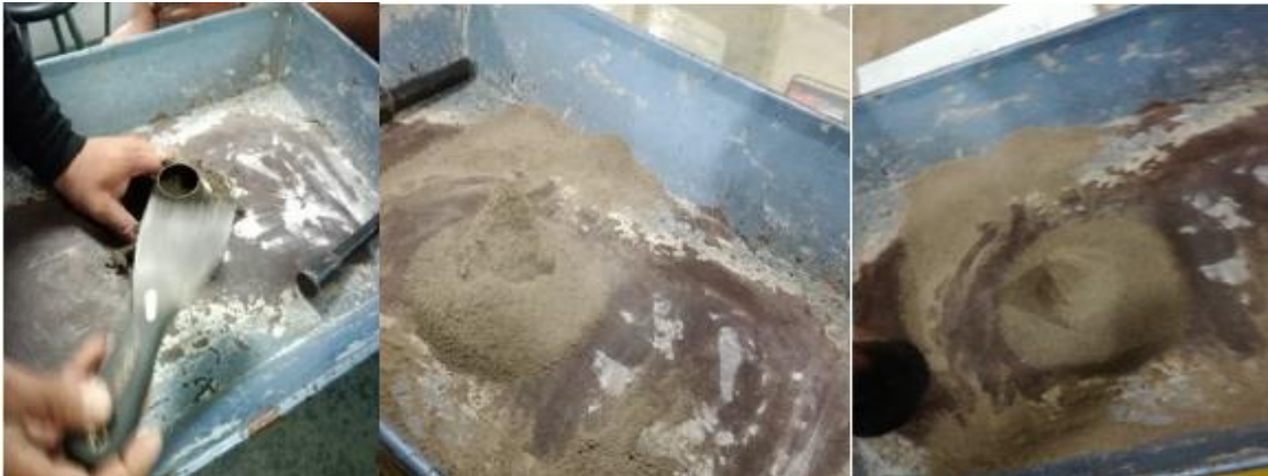
FIG. 3.2.4. 2 COLOCACION DEL MATERIAL EN EL CONO TRONCONICO Y CONDICIÓN SUPERFICIALMENTE SECA (AUTOR PROPIO)
