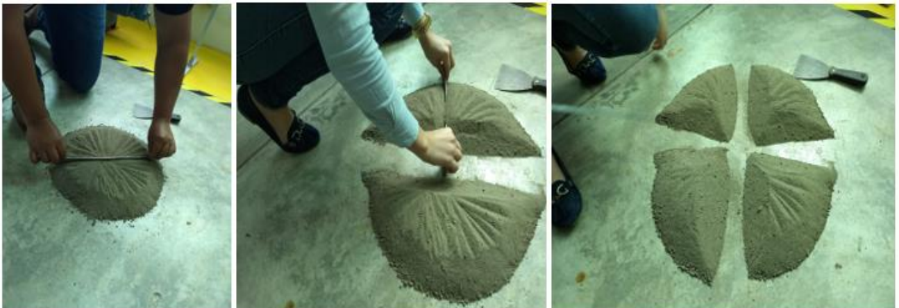
FIG. 3.2.1. 2 CUARTEO DEL MATERIAL (AUTOR PROPIO)
