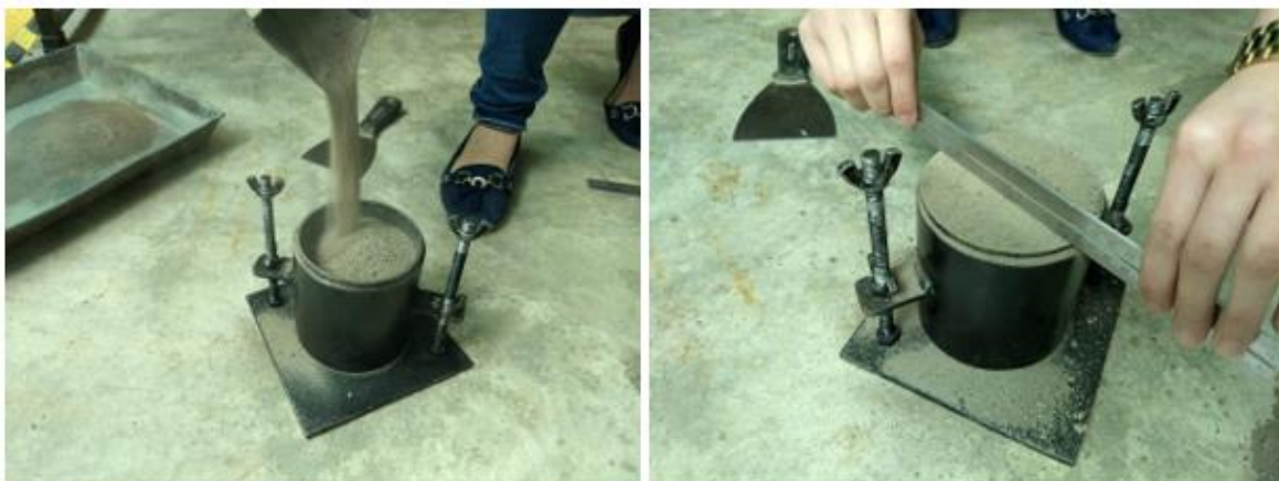
FIG. 3.2.2. 2 LLENADO Y ENRAZADO DE MOLDE PROCTOR (AUTOR PROPIO)
