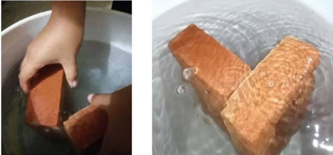
FIG. 3.3.2. 1 COLOCACIÓN DE LOS TABIQUES EN AGUA (AUTOR PROPIO)
