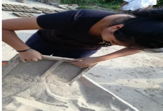
FIG. 2.2.7. 1 COLOCACION DE ARCILLA EN EL MOLDE(AUTOR: PROPIO)
