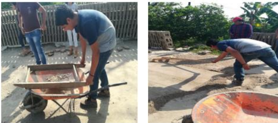
FIG. 2.2.5. 1 SERVIDO DEL MATERIAL Y COLOCACION EN EL PATIO DE SECADO (AUTOR: PROPIO)
