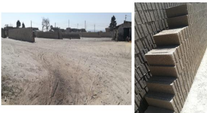
FIG. 2.1.6. 1 PATIO DE SECADO T BLOCK DE TEPETZIL (AUTOR: PROPIO)
