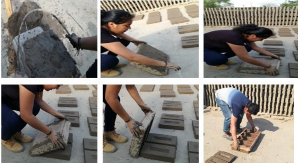
FIG. 2.2.9. 1 DESMOLDE DE TABIQUE (AUTOR PROPIO)
