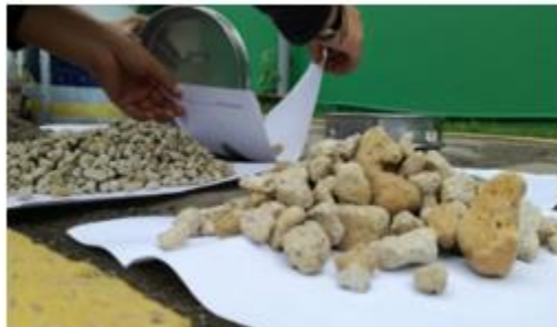
FIG. 3.1.2. 6 COLOCACION DE MATERIAL DE CADA TARA (AUTOR: PROPIO)
