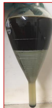
Figura 3.18 Determinación de porcentaje aceite, agua y sólidos. 2da etapa.
