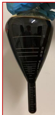
Figura 3.29 Prueba de centrifugado Muestra con desemulsificante.
