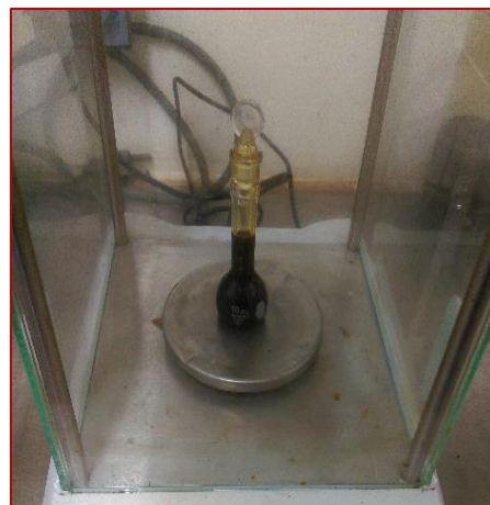
Figura 3.5 Determinación de porcentaje de sólidos, agua y aceite.
