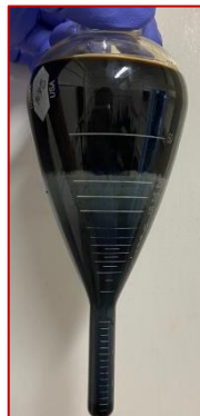
Figura 3.11 Determinación de porcentaje aceite, agua y sólidos. 1ra etapa.
