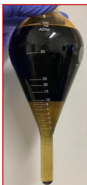
Figura 3.15 Determinación de porcentaje aceite, agua y sólidos. 1ra etapa.
