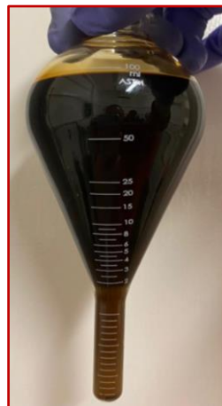
Figura 3.5 Determinación de porcentaje de sólidos, agua y aceite.
