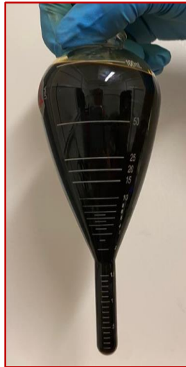
Figura 3.21 Determinación de porcentaje de sólidos, agua y aceite.
