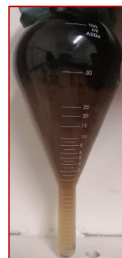
Figura 3.16 Determinación de porcentaje aceite, agua y sólidos. 2da etapa.
