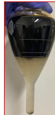
Figura 3.12 Determinación de porcentaje aceite, agua y sólidos. 2da etapa.
