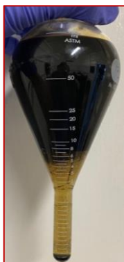
Figura 3.17 Determinación de porcentaje aceite, agua y sólidos. 1ra etapa.
