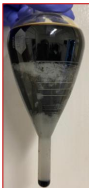
Figura 3.13 Determinación de porcentaje aceite, agua y sólidos. 1ra etapa.
