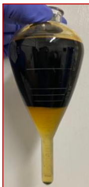
Figura 3.19 Determinación de porcentaje aceite, agua y sólidos. 1ra etapa.
