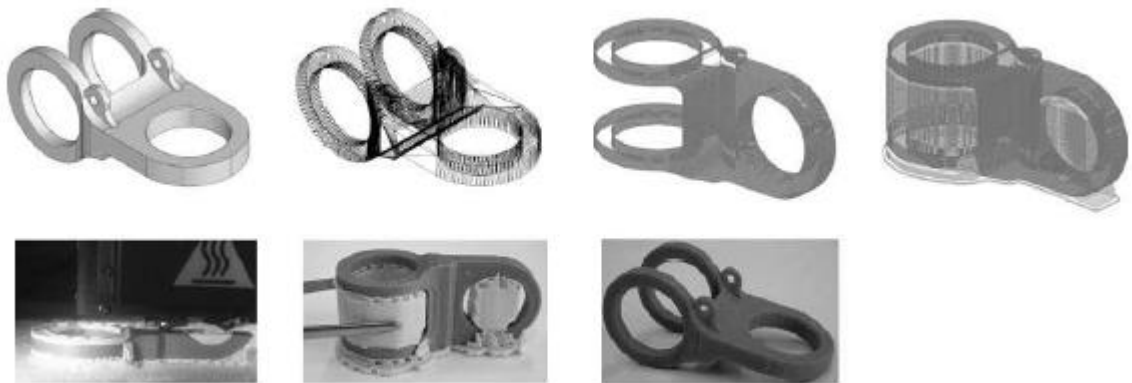
Figura 2-7 Proceso de rápido prototipado (Raja & Fernandes, 2008)
