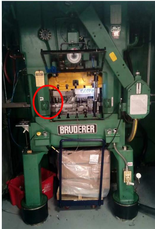
Figura 28: Ubicación del sensor dentro del troquel.
