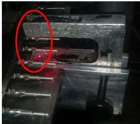
Figura 27: Herraduras con fibras de luz.
