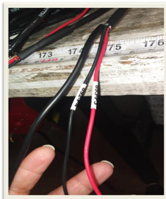
Figura 34: Cable CBL con gomas de identificación. Fuente: Fotografía tomada en el área de producción CBL.
