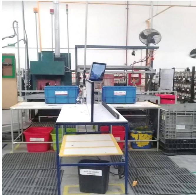
Figura 3.38 Hornos de fusión y mesas de trabajo con andón. Fuente: Cámara fotográfica de UFM
