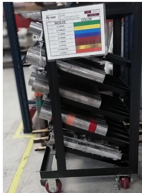
Figura 3.52 Rack con lista para identificar los complementos de los moldes para ajuste. Fuente: Cámara fotográfica de UFM.
