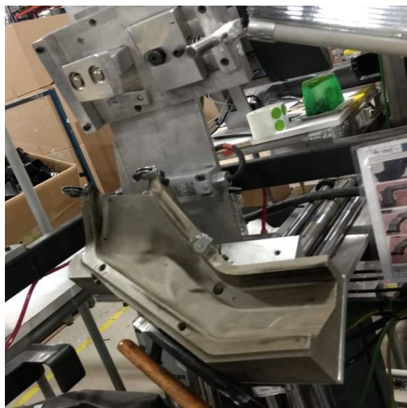
Figura 3.34 Dispositivo poka-yoke, formado por dos moldes de metal.
