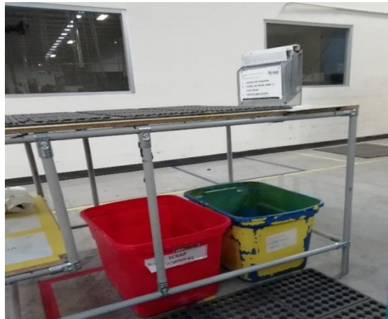
Figura 3.31 Mesa de trabajo con canasta de metal, donde son colocadas carpetas con los formatos de check list de limpieza, check list de arranque y check list de mantenimiento.
