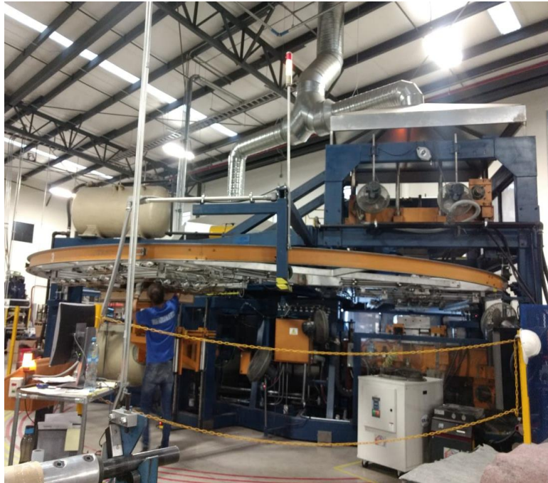
Figura 3.44 Termoformadora con implementación del andón. Fuente: Cámara fotográfica de UFM.
