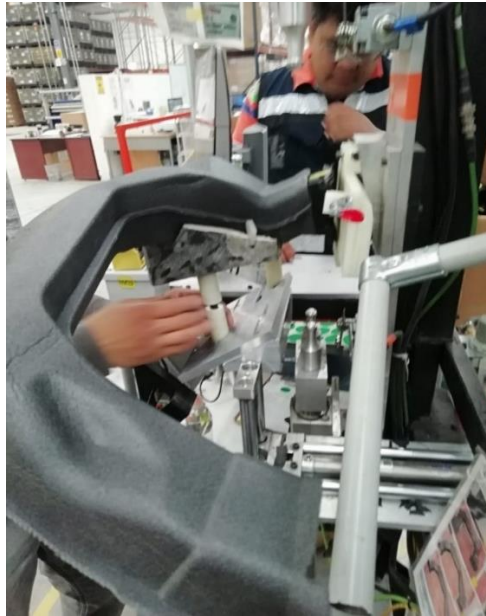
Figura 3.33 Proveedor de Poka-yoke haciendo pruebas y mediciones para la colocación del dispositivo.
