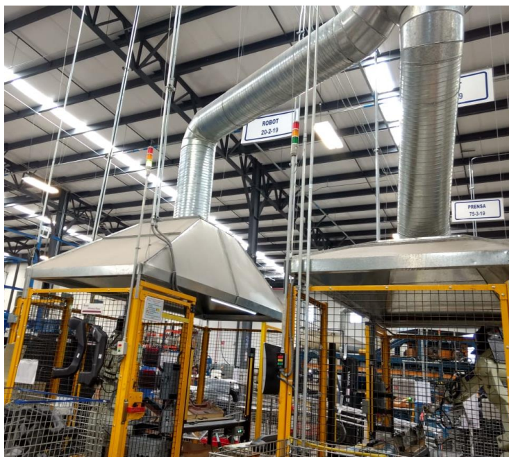
Figura 3.48 Robot 1 y 2 con la implementación del sistema andón en el area de termoformado. Fuente: Cámara fotográfica de UFM
