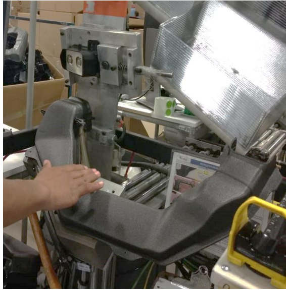
Figura 3.35 Collarín y ducto colocado en el poka-yoke. Fuente: Cámara fotográfica de UFM.
