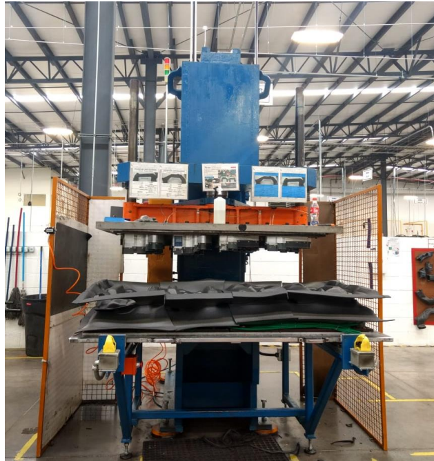
Figura 3.46 Prensa para ductos con el sistema andón implementado. Fuente: Cámara fotográfica de UFM.
